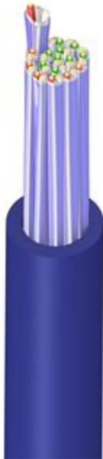
Conductor de Cobre desnudo. Aislamiento de Polietileno. Pareado de los conductores. Drenaje por par de Cobre estañado. Pantalla por par en cinta de Aluminio – Poliéster + Poliéster. Cableado de los pares. Protección de cinta textil. Cubierta exterior de PVC – NBR. 50 pares.
