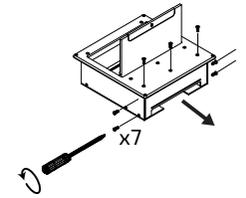
**5.** Si los pasos anteriores no son suficientes para conectar los cables, desatornillar los conectores del Panel de Conexiones (H), pasar los cables a través de sus taladros y conectarlos. Volver a atornillar los conectores en el Panel de Conexiones (H).
