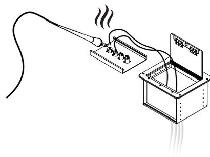
**6.** Determinar la mejor posición del Panel de Conexiones (G) para posteriormente poder cerrar la Puerta (B) con los conectores puestos.
