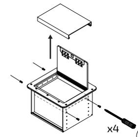
**4.** Meter los cables a través de la caja.
